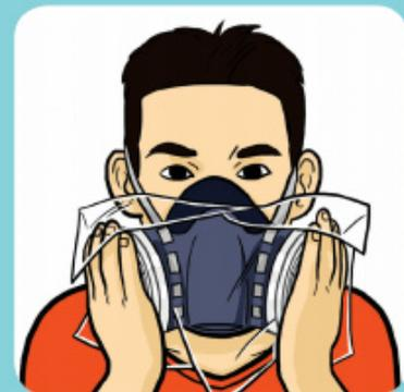
**6** Tester l'étanchéité : couvrir les filtres avec une feuille en plastique et inspirer ; le masque doit se plaquer sur le visage.
